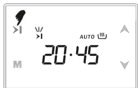
1) Отображается время окончания готовки (18:30+2:15=20:45).
