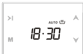
4) Спустя несколько секунд на дисплее отобразится текущее время суток и индикатор начала приготовления.
