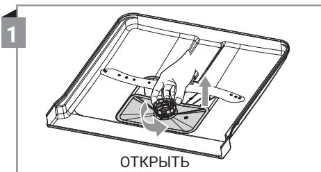
Чтобы извлечь фильтр, возьмитесь рукой за фильтр грубой очистки и поверните его против часовой стрелки. Потяните фильтр вверх и извлеките его из посудомоечной машины.
