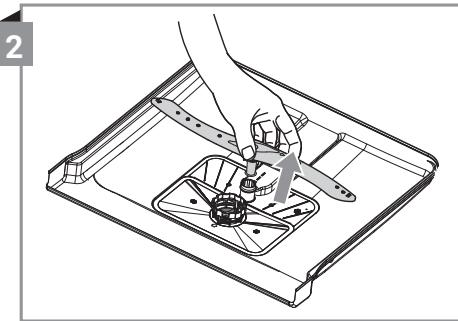
Чтобы снять нижний разбрзыгиватель, потяните его вверх.
