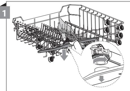
Чтобы снять верхний разбрзыгиватель, удерживайте гайку по центру разбрзыгивателя неподвижно и вращайте разбрзыгиватель против часовой стрелки.
