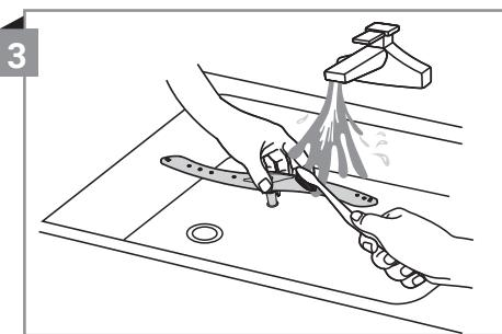
Вымойте разбрзыгиватели с мылом под теплой проточной водой. Прочистите форсунки мягкой щеткой. Затем установите разбрзыгиватели на место.
