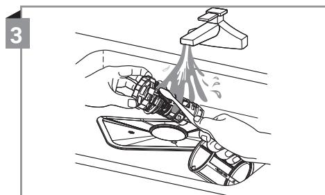
Для удаления более крупных остатков пищи промойте фильтр под проточной водой. Для более тщательной очистки используйте мягкую щетку.
