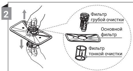
Теперь можно отсоединить фильтр тонкой очистки, расположенный в нижней части узла фильтра. Для отсоединения фильтра грубой очистки осторожно прижмите фиксаторы в его верхней части и потяните за него.
