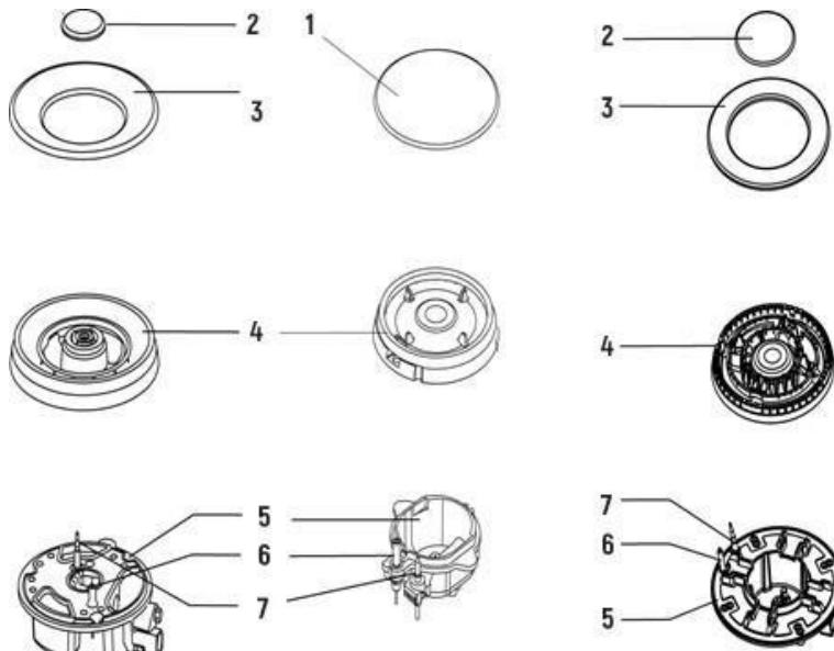
Поместите рассекатель (4) на чашу горелки (5) таким образом, чтобы устройство розжига и устройство контроля пламени прошли через соответствующие отверстия в рассекателе пламени. Рассекатель пламени должен быть правильно установлен. Поместите крышку горелки (1, 2, 3) на рассекатель пламени (4) так, чтобы фиксирующие штифты вошли в соответствующие выемки.
