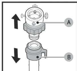
2. С помощью крестовой отвертки выкрутите четыре винта на переходнике.
