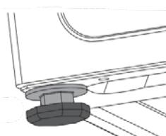
☞ Контргайка стоит в упор с основанием прибора.
