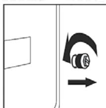
1. Ослабьте четыре транспортировочных болта с помощью гаечного ключа.
