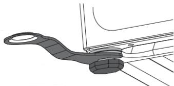
2. После того как вы разместили прибор, поочередно нажмите на углы стиральной машины и слегка потрясите ее, чтобы убедиться плотно ли ножки прилегают к полу.
