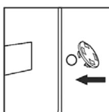
3. Закройте отверстия пластиковыми заглушками из комплекта поставки.
