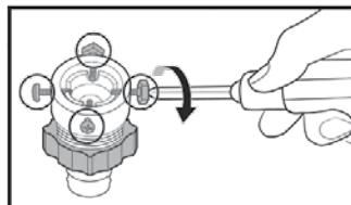
3. Поверните деталь (С) в направлении, указанном стрелкой, чтобы ослабить ее на 5 мм (\*).
