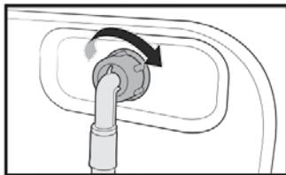
3. Откройте кран подачи воды и проверьте, нет ли протечек в местах соединения. Если вода протекает, повторите описанные выше действия.
