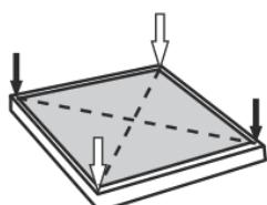
3. С помощью гаечного ключа ослабьте контргайку и выкрутите ножку до того, пока она не будет плотно прилегать к полу (как показано на рисунке).
