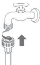
**3** Подсоединив заливной шланг к водопроводному крану, откройте кран и дайте воде протечь, чтобы удалить грязь и посторонние частицы (песок, опилки и т. д.), которые могли остаться в водопроводной трубе или шланге.
