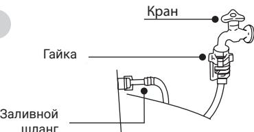
Накройте водопроводный кран и соединительные гайки горячим полотенцем.
