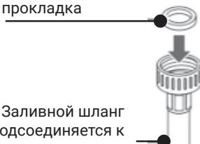
**2** Заливной шланг (подсоединяется к впускному клапану на стиральной машине)
