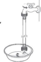
**4** Подсоедините шланг к впускному клапану, вручную закрутите гайку и затяните ее пассатижами, повернув на 2/3 оборота.
