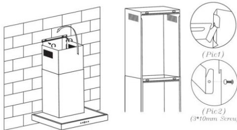
**Установка Sigma 50 PB BL / Sigma 50 PB WH / Sigma 60 PB BL / Sigma 60 PB WH / Sigma 50 Touch Black Glass / Sigma 60 Touch Black Glass с отводом воздуха внутрь помещения (режим рециркуляции)**
