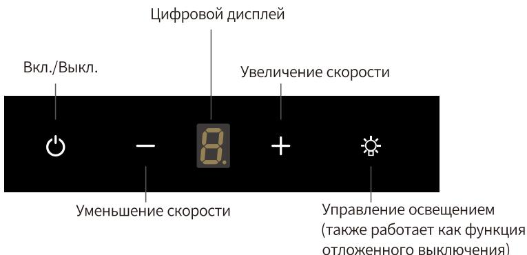
После включения питания все индикаторы загораются, затем гаснут в сопровождении звукового сигнала. В состоянии включения вытяжки элементы "Вкл./Выкл." и "Цифровой дисплей" всегда активны, и каждое нажатие сопровождается звуковым сигналом. Световой индикатор белый.
