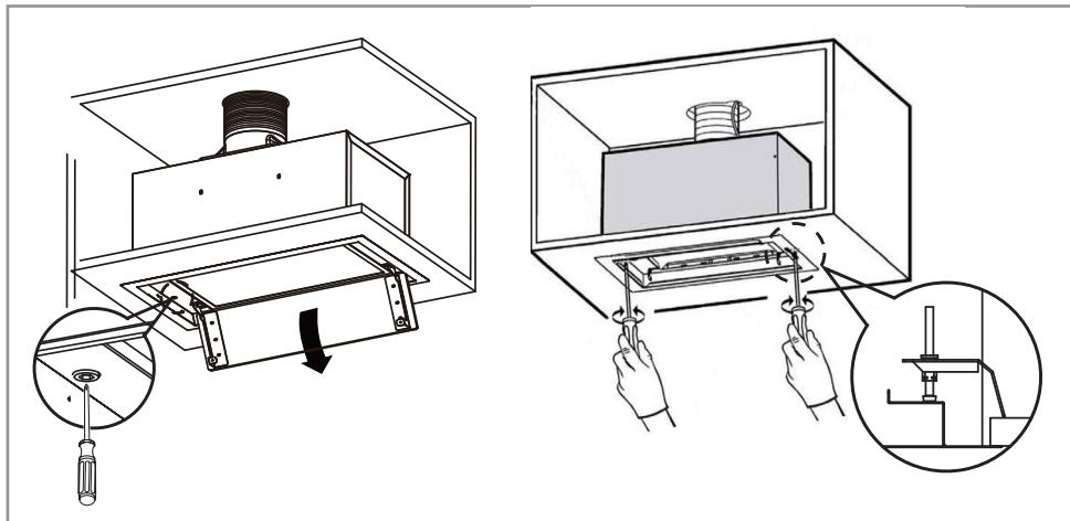
5. Если внутренняя ширина кухонного шкафа составляет 565~570 мм, вытяжку необходимо закрепить с обеих сторон четырьмя винтами ST4x18, прикрутив их с внутренней стороны корпуса вытяжки к стенке шкафа.
