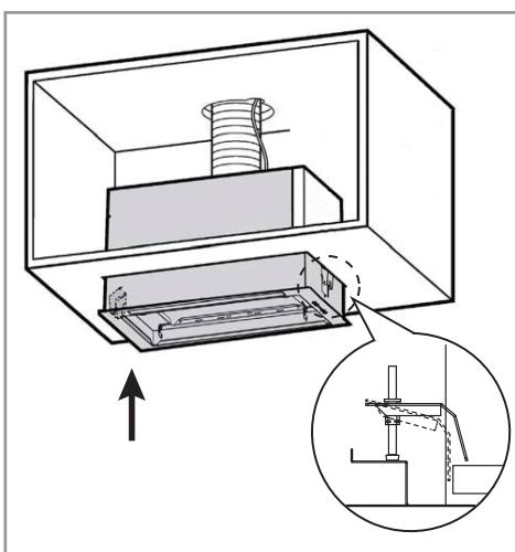
4. Откройте панель и отверткой открутите два крепежных винта. Поднимайте вытяжку вверх, пока она не будет полностью установлена в нижней части шкафа, а затем закрепите ее положение двумя винтами.
