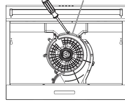
Для переключения в режим вентиляции модуль-вставка устанавливается в щелевое отверстие, расположенное на корпусе двигателя.
