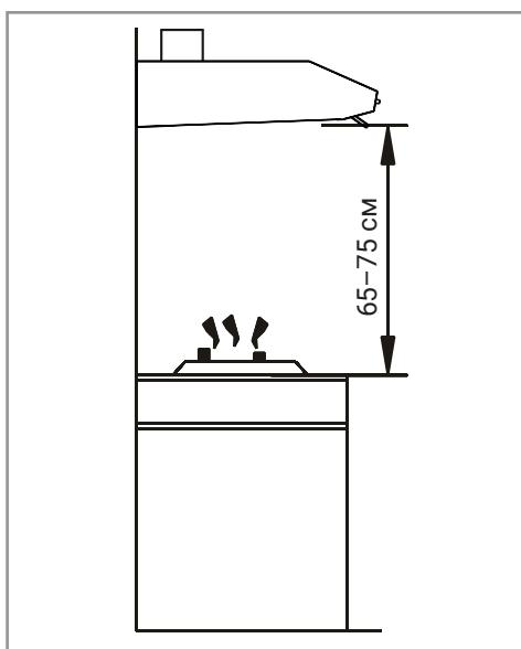
Перед установкой вытяжки в кухонный модуль убедитесь в том, что дюбеля и крепления обладают достаточной прочностью с учетом массы и габаритов устройства.
