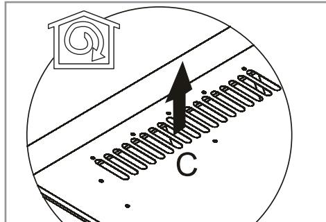
В режиме рециркуляции вытяжка не подключается к вентиляционной шахте. Воздух проходит через вытяжку внутри кухни и выходит через отверстие «С». Откройте его.
